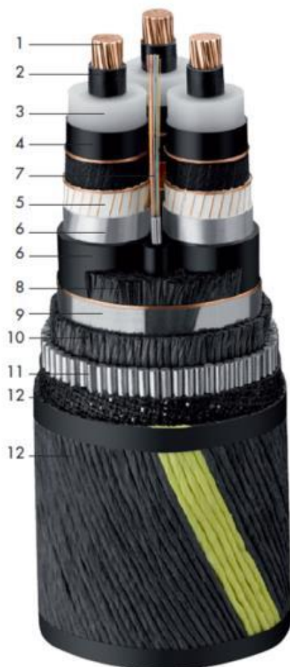
Rysunek 2.9. Budowa kabla trzyżyłowego AC [Źródło: Raport o oddziaływaniu Morskiej Farmy Wiatrowej Baltic Power na środowisko, 2020 [319]]
